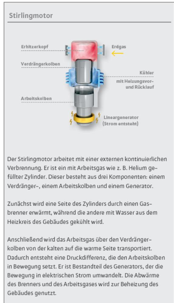
Abbildung 14: Stirlingmotorprinzip
