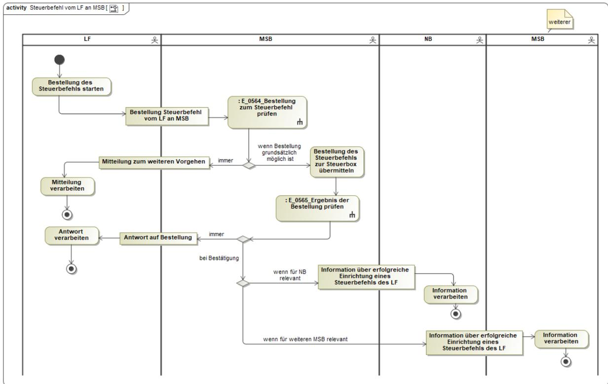
In dem AD „Steuerbefehl vom LF an MSB“ vorhandene Entscheidungsbaumdiagramme:
