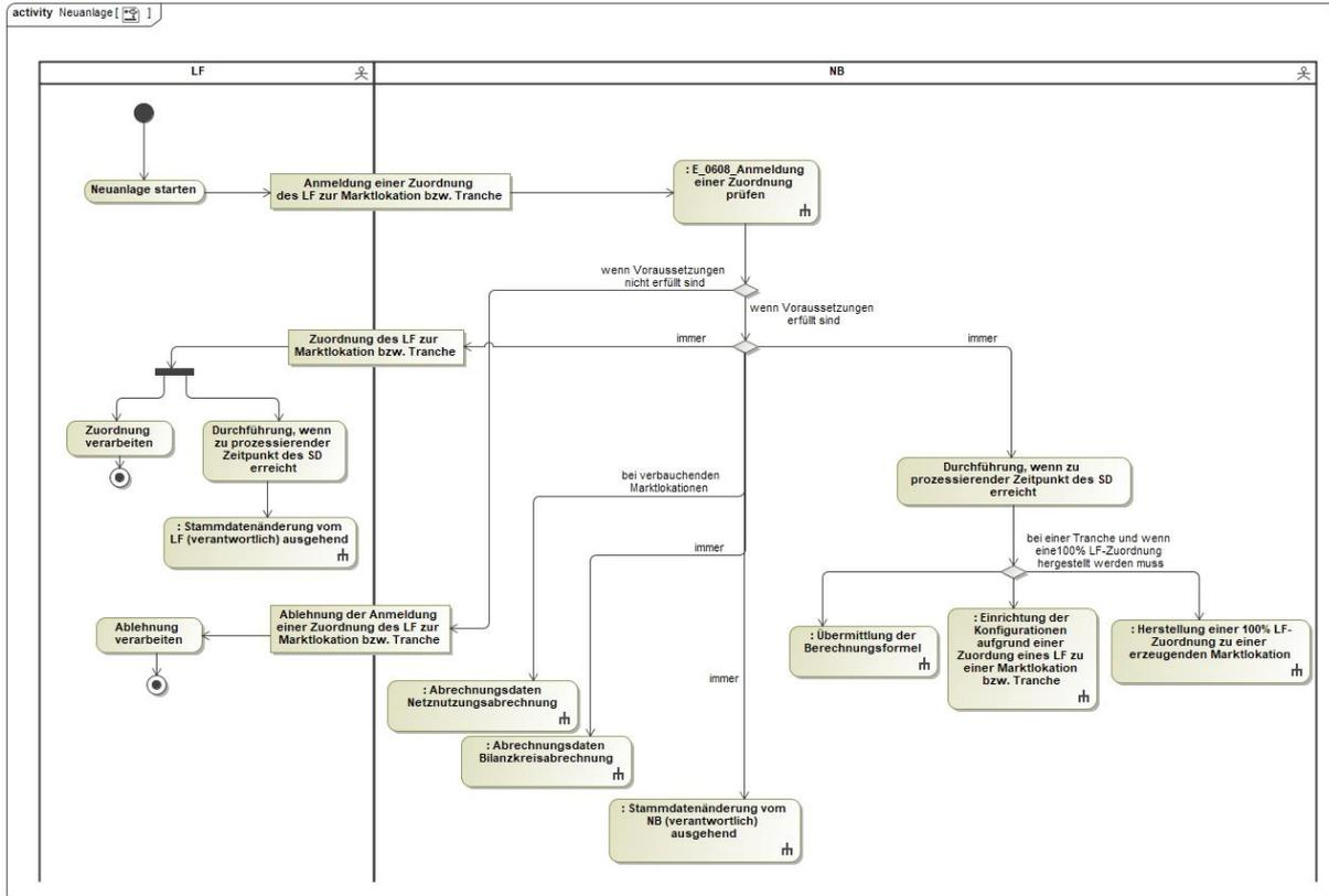
In dem AD „Neuanlage“ vorhandenes Entscheidungsbaumdiagramm:
