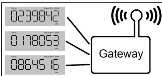
Abbildung 3: Intelligentes Messsystem
