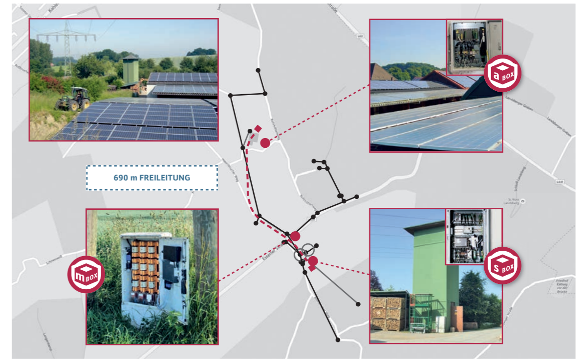
Netztopologie mit Darstellung aller Systemkomponenten: sBOX, mBOX und aBOX
