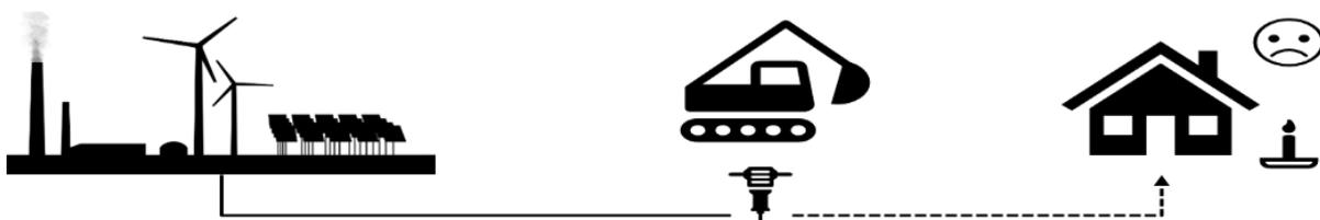
Abbildung: Fremdverursachte Versorgungsunterbrechung (schematisch)
