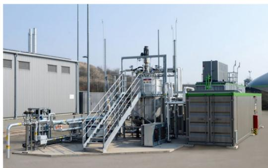
Die Power-to-Gas-Anlage in Allendorf: Die Methanisierung durch Mikroorganismen findet in dem silbrig glänzenden Druckbehälter (unteres Bild, Mitte) statt.
