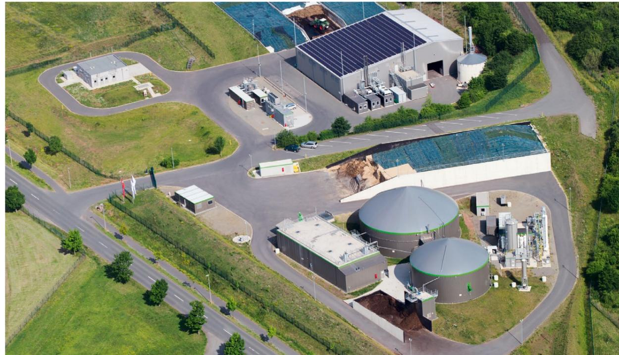
In den beiden Fermentern (vorne) wird Biogas erzeugt. Das dabei anfallende Kohlendioxid wird von Mikroorganismen bei der Methanisierung von Wasserstoff (Bildmitte) genutzt. | Fotos: Viessmann Werke
