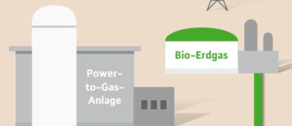
Das gilt genauso für grünes Gas zum Beispiel aus der Power-to-Gas-Technologie: Bei diesem Verfahren wird klimaneutral erzeugter Strom dafür genutzt, Wasser in Wasserstoff und Sauerstoff aufzuspalten. Der Wasserstoff kann in das Erdgasnetz eingespeist werden und vermischt sich dort mit dem im Netz vorhandenen Erdgas.
