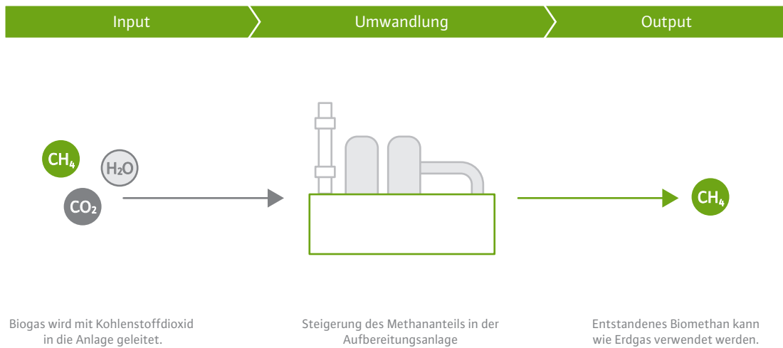
Schema der Biomethan-Aufbereitung
